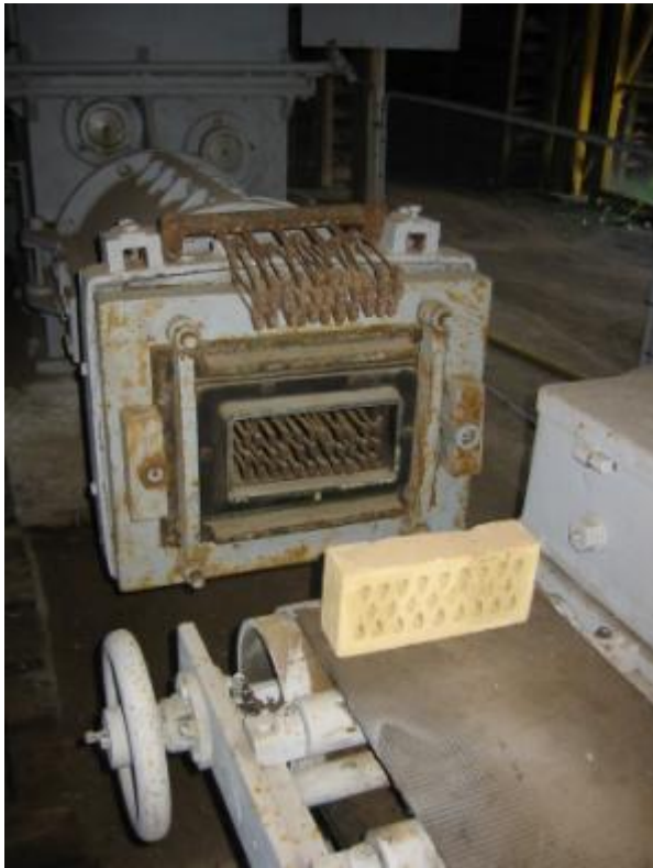
Stringpresning af mursten på en maskine. Her såkaldte 'mangehulssten'.
