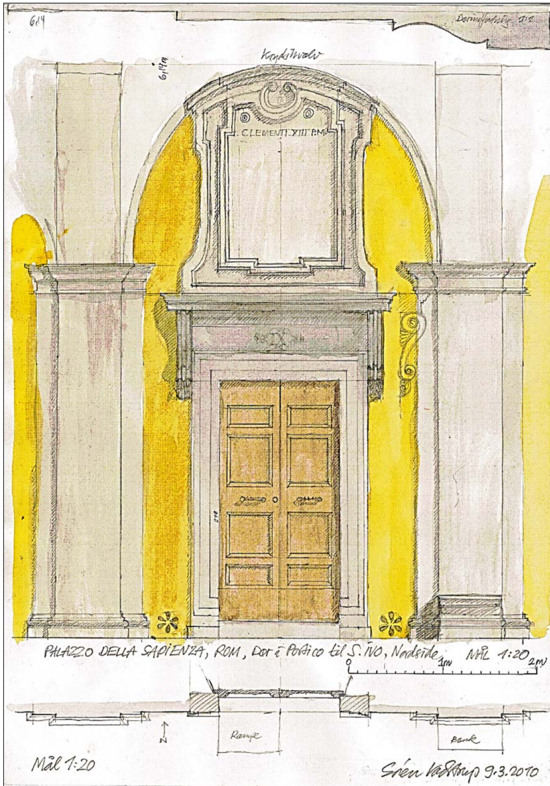
Relativ opmåling/skitseopmåling af dør i Palazzo della Sapienza (Borromini 1632-67) i Rom. Mål 1:20 med detalje af dørindfatningen (øverst) 1:1. Akvarel påført på stedet.
