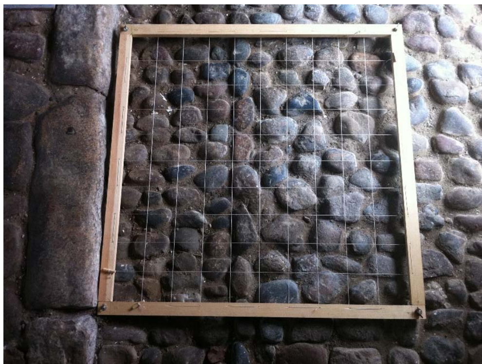
Kvadrat-net på 1 x 1 meter, med 10 x 10 cm masker, der kan klappes sammen.
