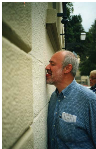
Ja, det passer. Man kan smage på murværket med tungen, om der er salte, og hvilke, om det er kalket eller plastikmalet eller om der er aflejringer af gips. De fire andre sanser er også nyttige.
