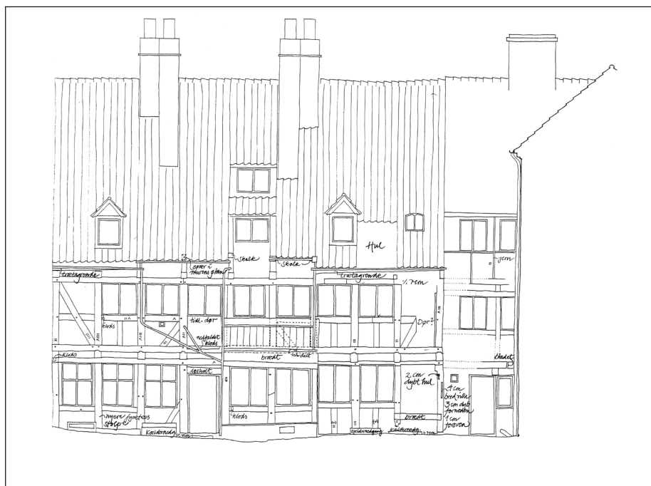
Facadeopmåling med registrering af detaljer og spor. Huset har oprindeligt haft svalegang fra 3. til 6. fag fra venstre. Tegning af Bente Lange
