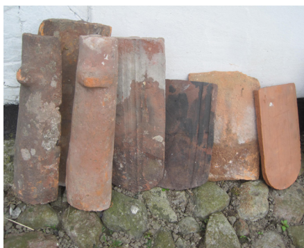
Historiske tagstenstyper. Fra venstre: Munke-nonnetagsten i den særlige danske udgave til de meget stejle nordiske tage, bæverhaler i forskellige størrelser.
