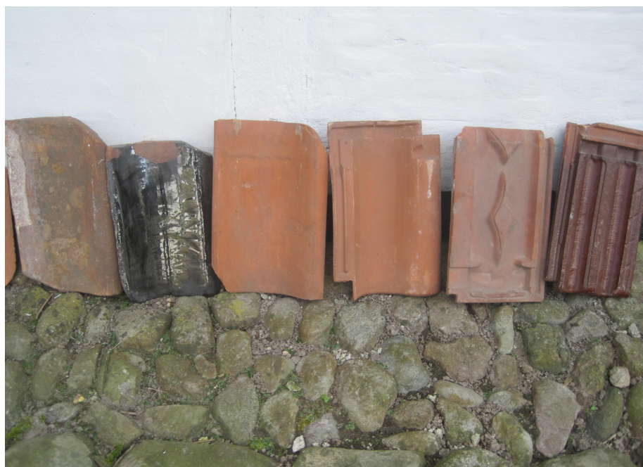
Nyere tagstenstyper: Fra venstre: håndstrøget tagsten fra midten af 1700-tallet (stadig intakt), sortglaseret tagsten, stringpresset maskintagsten fra 2000, falstagsten fra 1950'erne, falstagsten med rhombemotiv fra 1850'erne og rødglaseret falstagsten fra 1950'erne.
