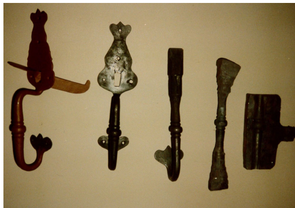
Fremstilling af et klinkefald. Yderst til højre ses sænkens ene del, derefter den sænkesmedede dekoration på selve håndtaget. Der er afsat materiale til de to endepalder. Herefter smedes de kunstfærdige endepalder ud og løftepalen smedes og monteres.
