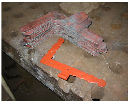
Kopier af vinduesbeslag fra 1750'erne udført i smedjen i Raadvad. Beslagene essesmedes på samme måde som oprindeligt, hvilket betyder at de bliver meget kompakte i strukturen, og derfor meget holdbare. Grovformen smedes ud, hvorefter den præcise form og detaljering hugges ud i det glødende jern.
