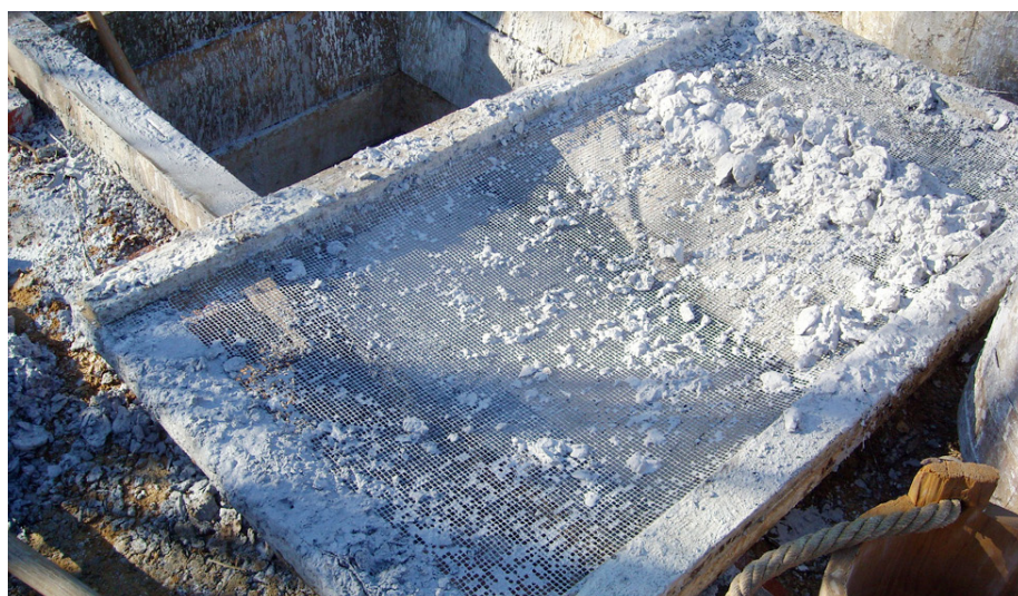
Den vådlæskede kalk opbevares i kuler (grave), der skal være frostfri. Under lagringen findeles kalken, og urenheder synker til bunds. Når den læskede, såkaldte kulekalk blandes med sand eller grus og udsættes for luftens påvirkning, afbinder (karbonatiserer) den, og kalken bliver igen til kridtsten. Foto: Historic Williamsburg, USA
