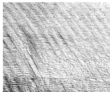
Spor efter udsavningen på træets langside. T.v. rammesav, bloksav eller båndsav. T.h. rundsav. Foto: Niels Holger Larsen.
