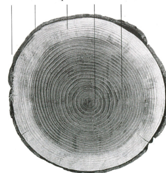
På et gennemskåret fyrretræ kan man tydeligt se det mørkefarvede kernetræ, der har stor modstandskraft og holdbarhed fordi det er selvimpregneret med harpiks, olie- og tjærestoffer. Dette træ kan ikke yderligere imprægneres kunstigt. Det lyse splintved, derimod, holder ikke nær så længe, men afhængig af de øvrige træbevaringsmetoder, konstruktiv træbeskyttelse og olieholdig overfladebehandling, kan det dog sagtens holde i mange hundrede år.
