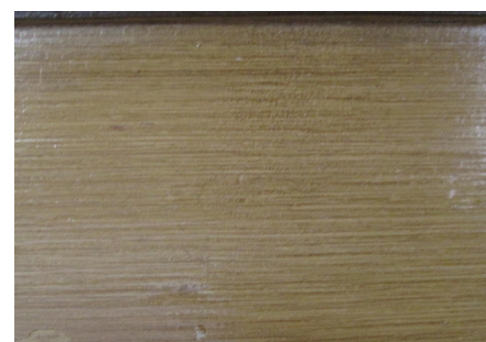
Ved lasering er sporene efter penselen og de trukne strøg det, der giver laseringen karakter. Farverne er ofte brun på gul bund som her, blågrå på hvid bund eller rød på hvid bund, men man kan i princippet lasere med alle pigmenter og farver.
