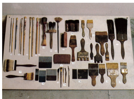
Pensler og værktøj til imitationsmaling: 6: schatteringspensel. 10: bølgemodler. 11: modlere i forskellige bredder. 13: ilægger til vandådring. 14: forskellige tildannede modlere. 15: ådrefordrivere. 16: ådrekamme af stål. 17: ådrekam af træ. 19: ådrelæggere før og efter opsætning i lim og shellak. 20: tildannet gummi til ådring. 21: vandådrelæggere i forskellige bredder. 22: ådrelægger i metal (gaffelpensel). Foto: Arne Bäck.
