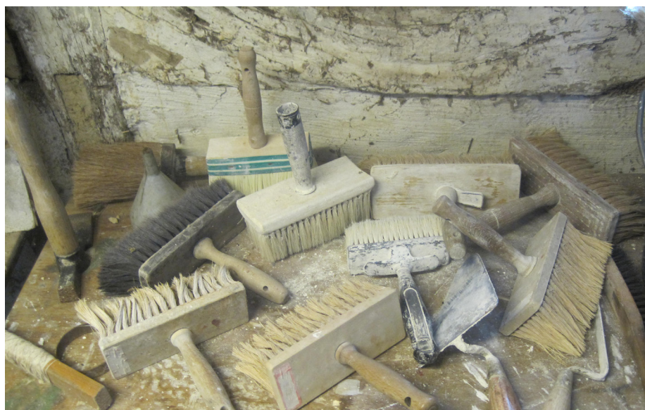
Kalkkoste og andre redskaber til spækning og kalkning af murværk.
