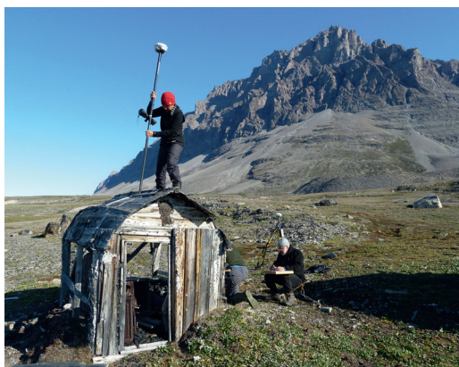
Opmåling af den norske fangsthytte 'Kongeborgen' – med bjerget Kongeborgen i baggrunden. Satellit-opmåling af taget ved Inge Bisgaard og traditionel opmåling med papir, blyant, vandslange, målebånd og tommestok af Thomas Haurberg Hansen og Søren Vadstrup. Foto: Peter Schmidt Mikkelsen.
