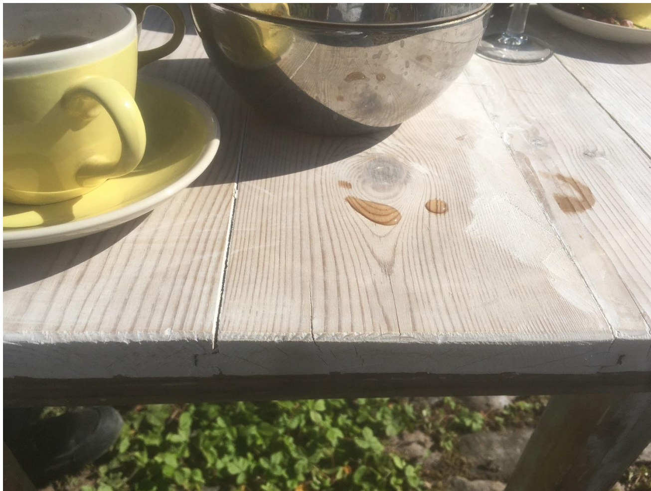
Bordplade på et havebord, behandlet med kalksæbe-behandling. Læg mærke til hvordan vanddråber perler af på overfladen – i noget tid, før de suger ind.
