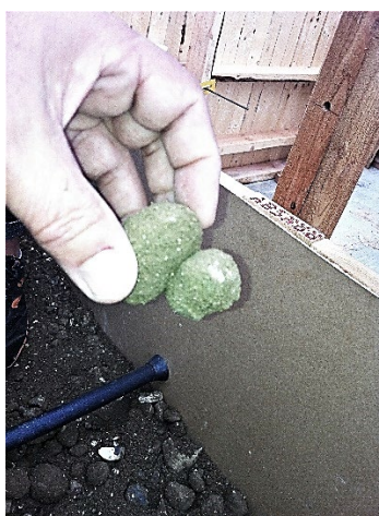
Lerblandingens rette fugtighed afprøves ved 'klæbemetoden' – her fra bygningen af et pisé-hus på KADK i 2013. Til højre en lidt enklere pisé-metode med løse formbrædder sat mod udvendige stolper – fra Cointeraux's bog.
