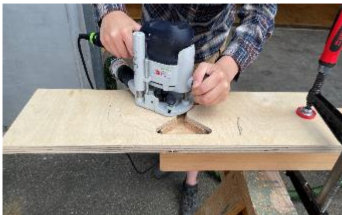
Maskinfræsning af remmenes 'krydskæmning' efter fræseskabeloner. Til højre er hele bundremmen samlet, med de særlige 'låste' hjørnesamlinger med taphul til stolpen og vandrette noter til vægplankerne.
