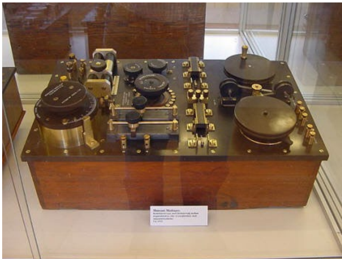
MARCONI krystalapparat med magnetisk detektor
