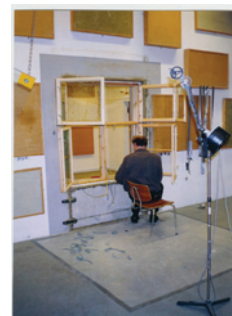
Ovennævnte forsøg er udført af firmaet „DELTA Dansk Elektronik, Lys & Akustik „ og findes i Teknisk Notat v/ Henrik S. Olesen: Laboratoriemålinger af lydisolation for Raadvad-Vinduerne 1850 og 1920 AV184/03 af 2. juli 2003
